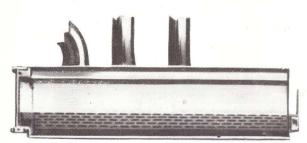
Dans le **pré- épurateur,** qui se trouve au-dessous du réfrigérant à eau du moteur, le courant de gaz est contrarié. Ici, le gaz et l'eau qui se dépose entrent en con-
