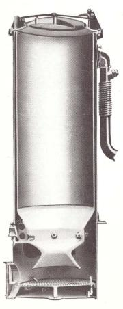
Les dimensions et la forme de toutes les pièces sont établies d'après une longue expérience. Malgré les différences des nombreux véhicules équipés avec l'installation Imbert, il n'existe qu'un nombre réduit de modèles de pièces. Des modèles-type normalisés construits en grande série et interchangeables s'adaptent parfaitement à tous véhicules.
