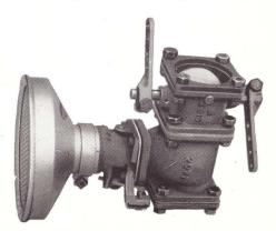
d'aspiration. Le papillon d'admission d'air, le papillon à main pour le gaz et l'essence sont réglés par des câbles Bowden.
